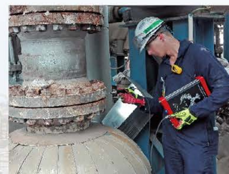
PHX21火焰离子检测仪与手持终端蓝牙同步，实时显示泄漏浓度，并记录最高峰值，找到最大泄漏点。
